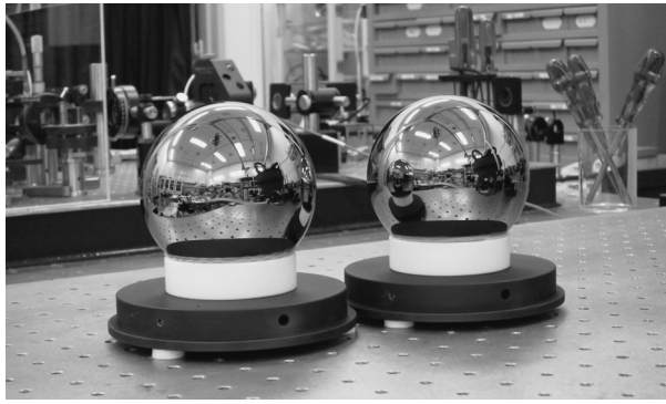
写真3 ^{28}\text{Si} 単結晶球体 (写真提供: 産業技術総合研究所。アボガドロ定数高精度測定のためにアボガドロ国際プロジェクトにより製作された。1個あたりの製造費用は約1億円である。)
