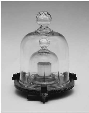
写真2 茨城県つくば市の産業技術総合研究所で保管されている日本国キログラム原器（写真提供：産業技術総合研究所。国際キログラム原器の複製の一つであり、我が国の質量の国家標準として維持・管理されている 2) 。）
