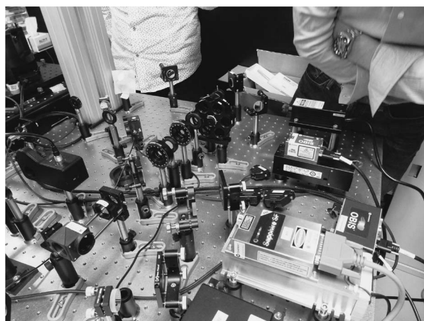
写真3 さまざまな励起光源を備えた顕微分光システム
